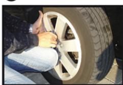
Nasadte kolo a nové delší šrouby rukou pevně zašroubujte. Pro bezpečné upevnění kola přitom dbejte na předepsaný minimální počet závitů dle tabulky „Minimální hloubka zašroubování upevňovacího materiálu (šroub nebo matic)“
